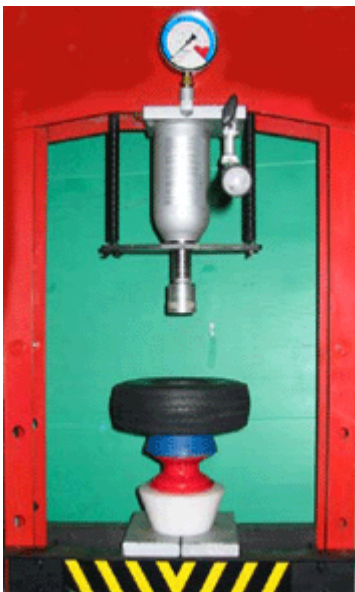
Poser le bandage plein sur le cone
