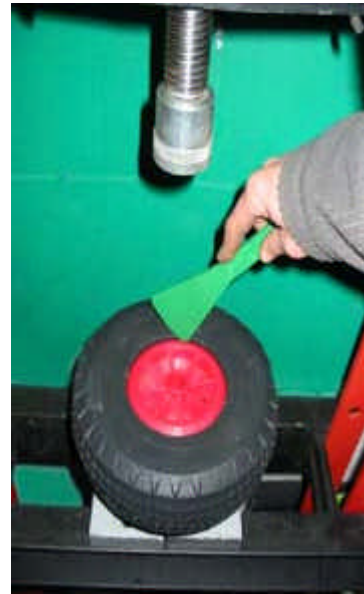
Si nécessaire, repousser le talon du bandage derrière le flanc de la jante
