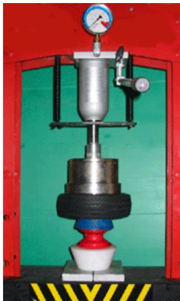
Poser la virole sur le bandage puis descendre le piston de la presse
